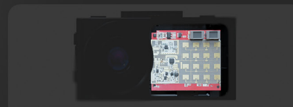
Уникальная комбинация большой патч-антенны и модуля XDR
